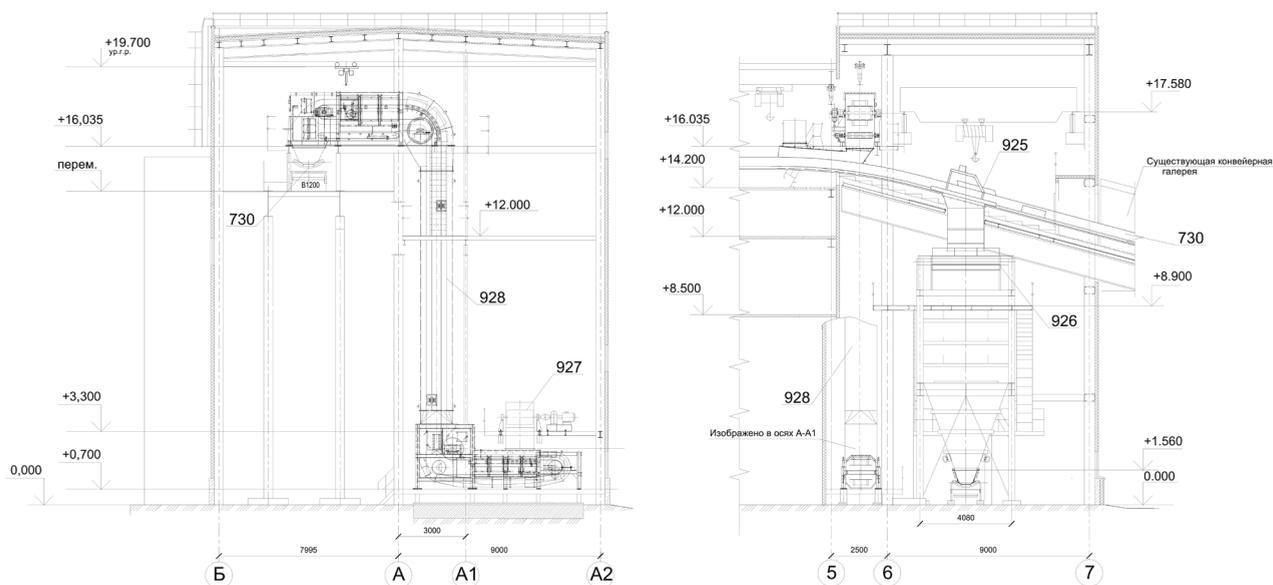
Рис. 2. Здание сортировки: поз. 730, 927 — ленточный конвейер; поз. 925 — плужковый сбрасыватель; поз. 926 — грохот сухой классификации «Liwell»; поз. 928 — крутонаклонный конвейер «FLEXOWELL»
